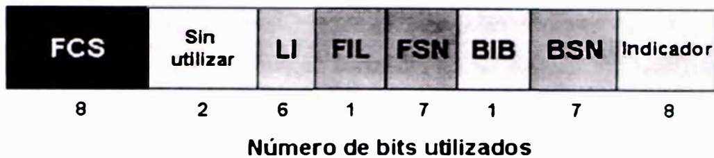
Figura 4.2.- Campos de la unidad de señal fill-in
