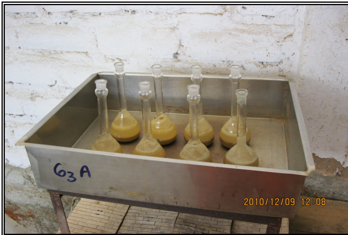
FOTO N° 27: ELIMINACION DE LAS BURBUJAS POR CALENTAMIENTO EN ESTUFA
