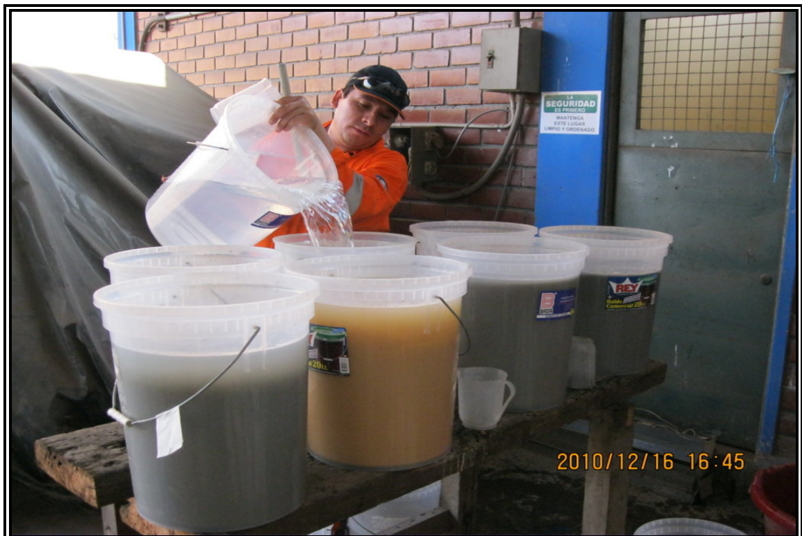
FOTO N° 18: LAVADO DE LOS RELAVES DE LAS PRUEBAS DE CIANURACION EN BOTELLAS
