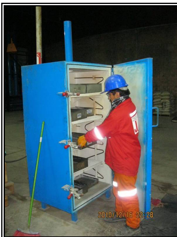
FOTO N° 20: SECADO EN ESTUFA DE LOS RELAVES DE LAS PRUEBAS DE CIANURACION EN BOTELLAS
