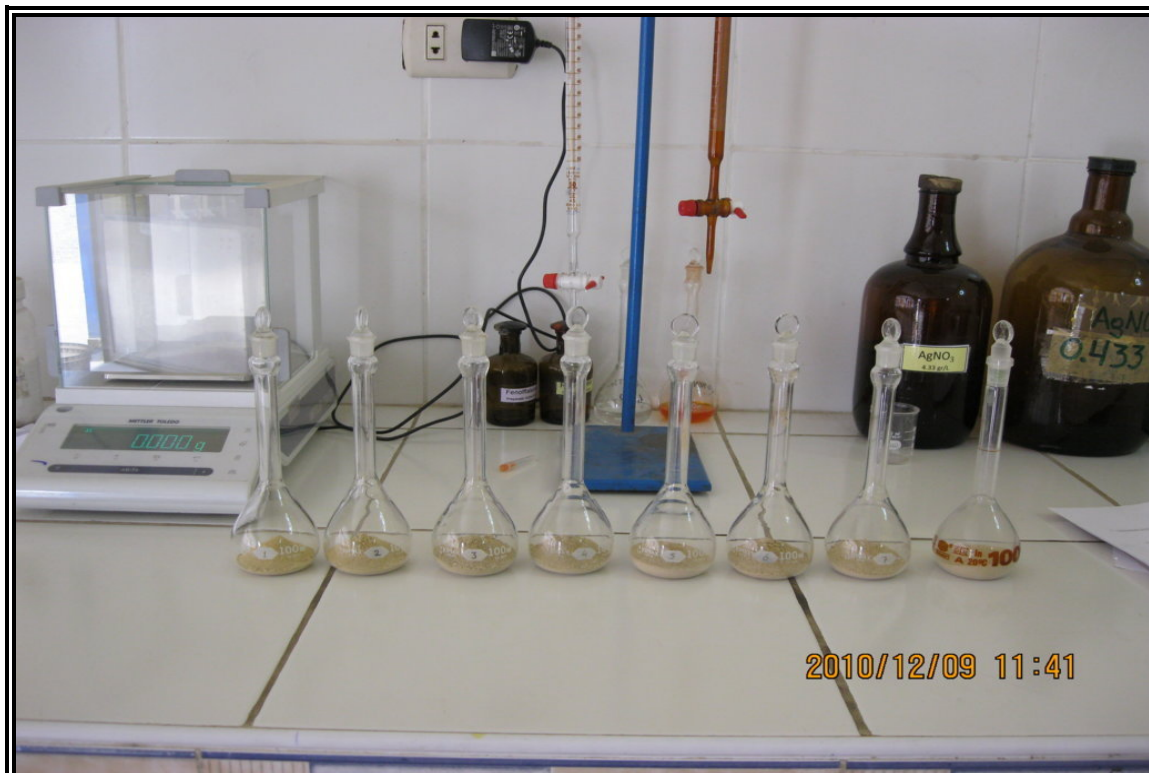
FOTO N° 26: DETERMINACION DE LA GRAVEDAD ESPECÍFICA, METODO DEL PICNOMETRO
