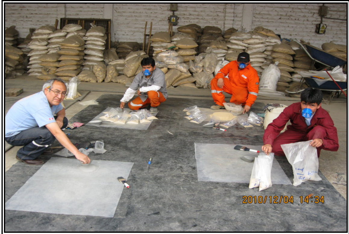
FOTO N° 9: MUESTREO POR INCREMENTOS (METODO DEL CONO)
