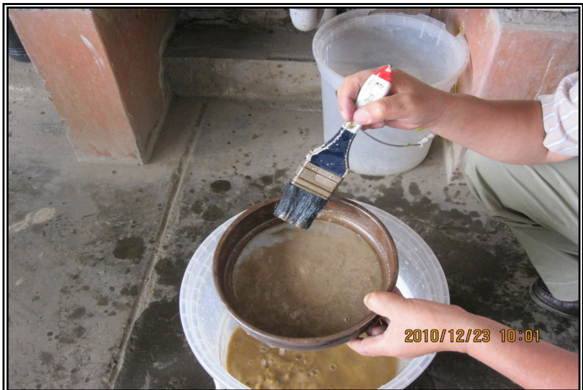
FOTO N° 22: PRUEBA PARA EL ANALISIS DEL % DE MALLA 200
