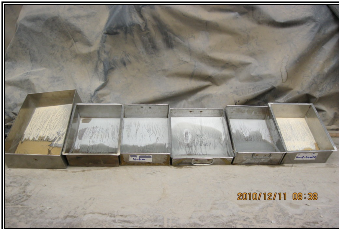
FOTO N° 19: DECANTACION DE LOS RELAVES LAVADOS DE LAS PRUEBAS DE CIANURACION EN BOTELLAS
