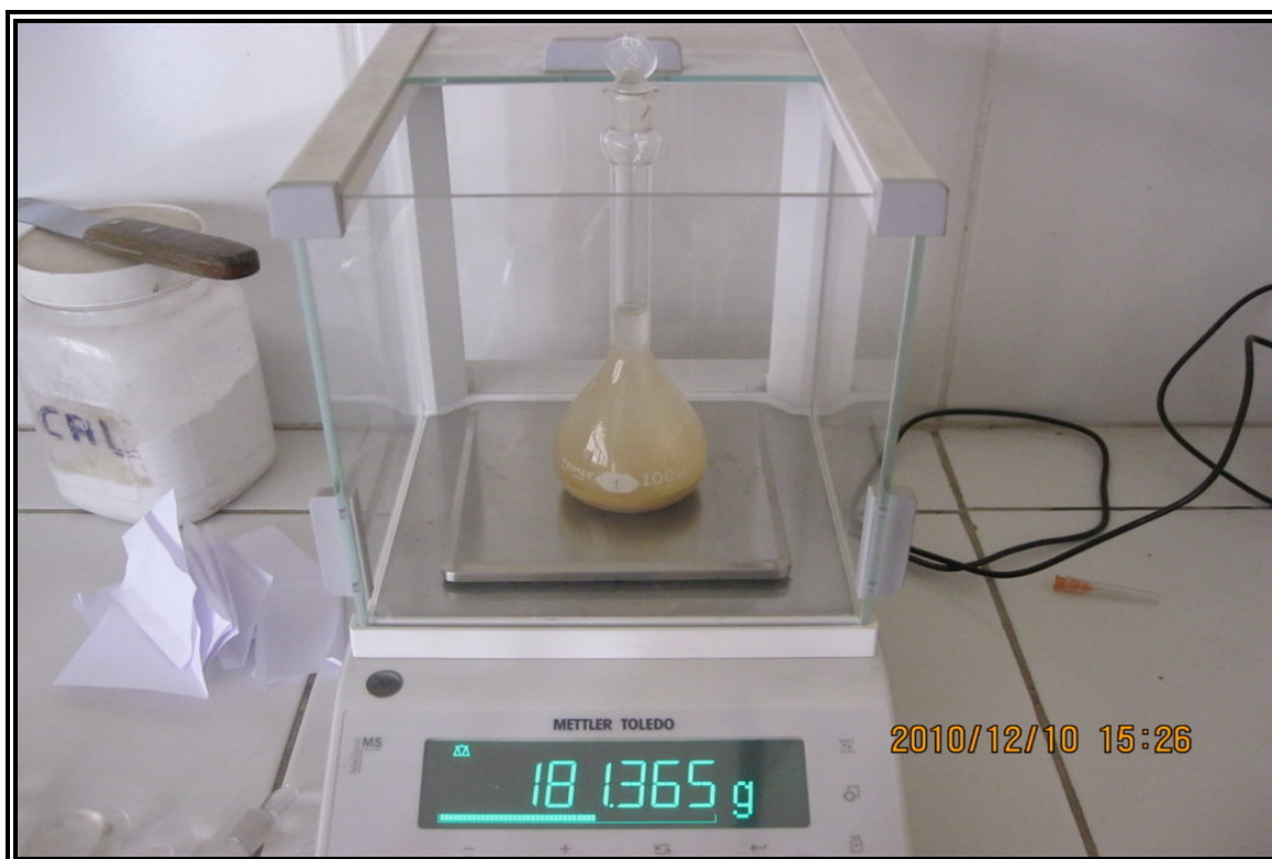
FOTO N° 28: PESADO DEL PICNOMETRO MUESTRA + AGUA
