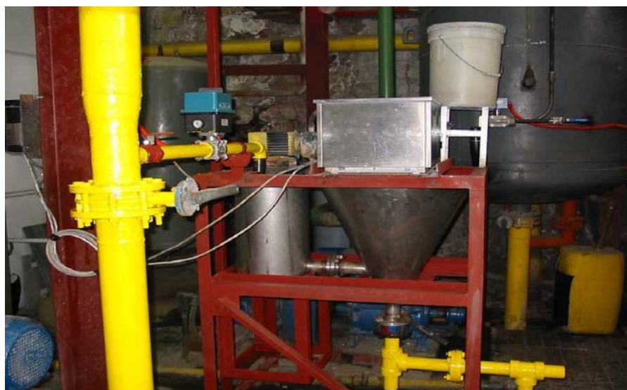
Figura 3.18. – Zona de precipitado con polvo de zinc
