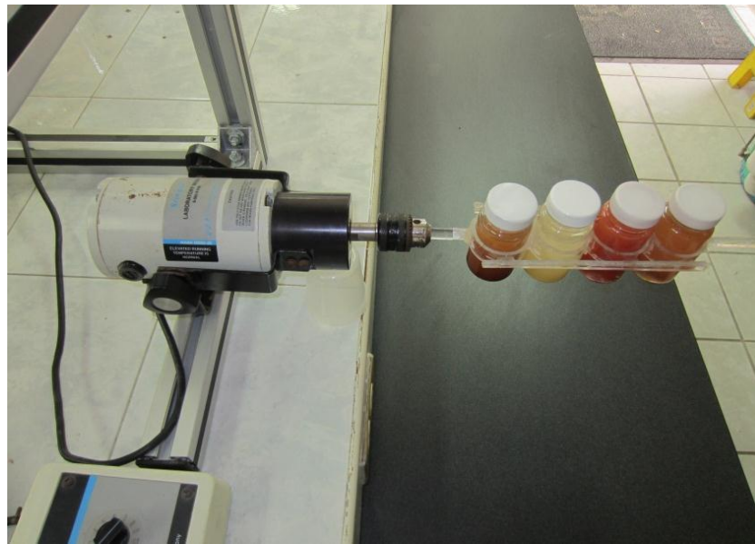
Figura 20: Sistema de lixiviación para evaluar la toxicidad de residuos
