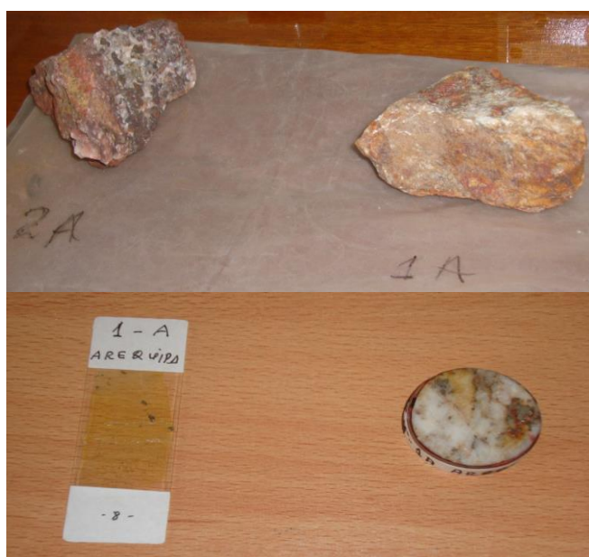
Figura N° 17: Muestras de mineral 1A y 2A y secciones delgada y pulida para análisis microscópico
