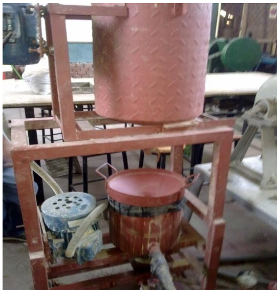
Figura N°20: Concentrador gravimétrico Falcón
