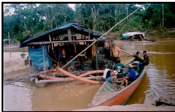
Figura N° 7: Operación aurífera artesanal en la Selva, método de Balsa (Succión y bombeo)
