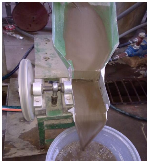
Figura N° 21: Concentrador gravimétrico Jig con carga
