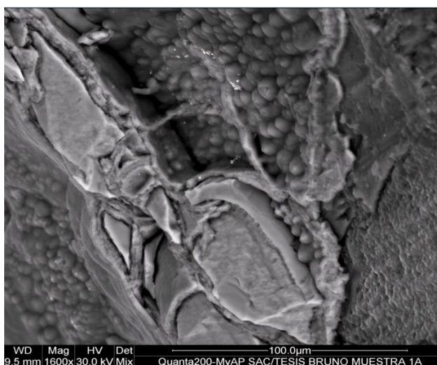
Figura N° 29: Microfotografía de imagen MEB MIX mostrando oro libre asociada a los agregados botroidales de óxidos de hierro
