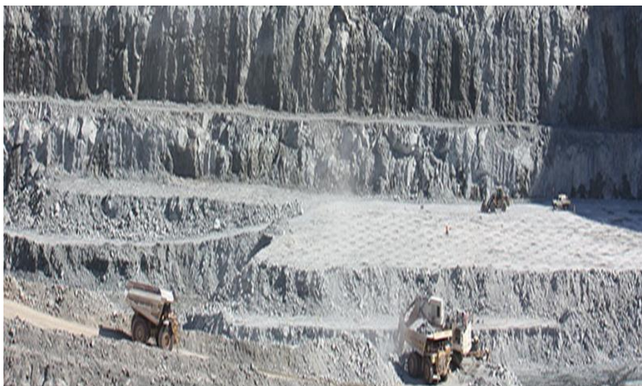
Figura N° 5.7: Muestra los bancos con sobre fracturamiento, debido al mal diseño de las mallas de perforación y voladura.
