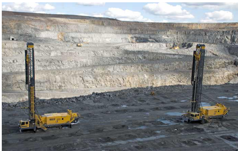
Figura N° 3.2: Muestra dos perforadoras rotativas usadas en minería superficial.
