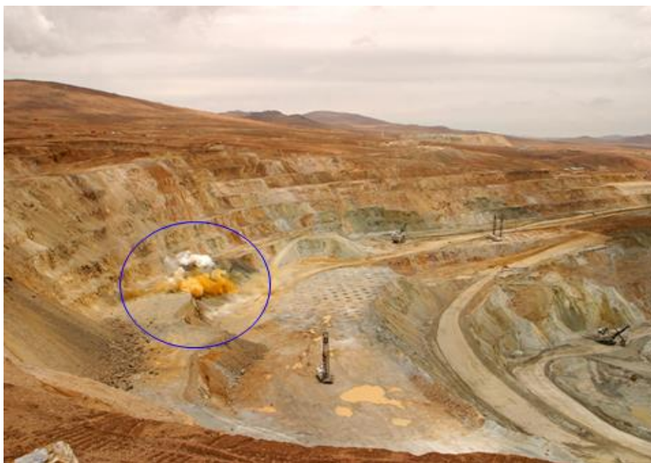
Figura N° 5.6: Muestra la detonación de un disparo primario.
