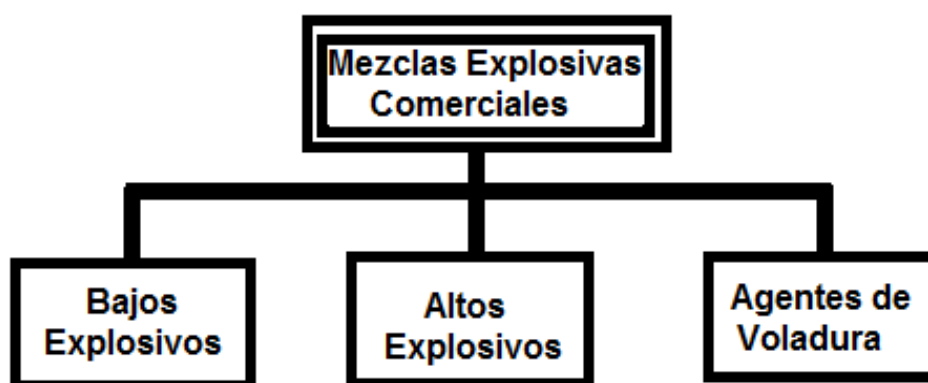
Figura 3.3: Muestra la clasificación de las mezclas explosivas comerciales usadas en la voladura de rocas.
