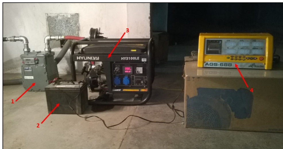
Figura 6.1 Banco de pruebas. 1. Flujómetro analógico, 2. Batería de encendido, 3. Grupo electrógeno modificado, 4. Analizador de los gases de escape.
