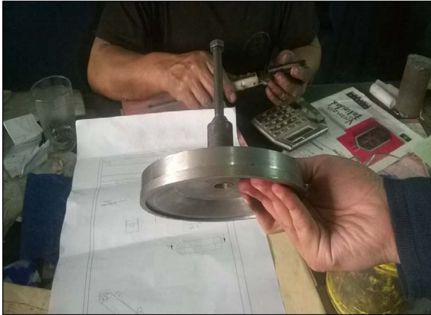
Figura 5.3 Construcción de la tapa superior del regulador de biogás.
