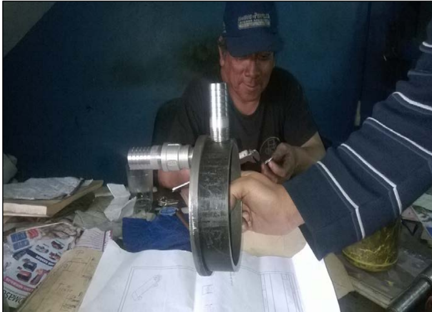
Figura 5.4 Construcción de la entrada y salida de biogás del regulador.
