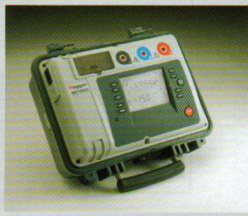
FIG 9. Equipo de medida de resistencia de aislamiento e Índice de Polarización (10kV) Megger.
