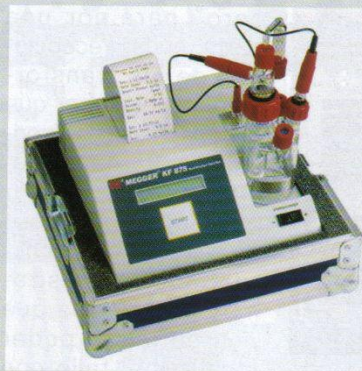
FIG 13. Equipo de determinación de humedad disuelta en aceite.
