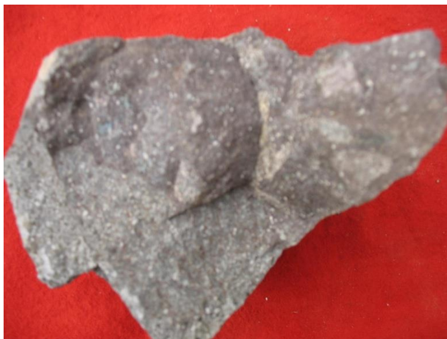
Fotografía N° 11.- Roca de zona de fallamiento del área de estudio fuertemente alterado y fracturado (A2)
