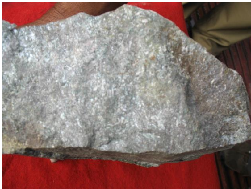
Fotografía N° 12.- Roca andesita fuertemente alterada tomada de la zona de alteración propilítica
