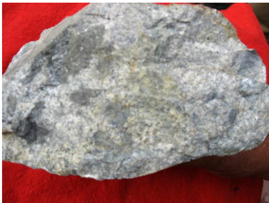
Fotografía N° 9.- Roca pórfido de andesita fuertemente alterado (Silicificación) y diseminación de sulfuros.
