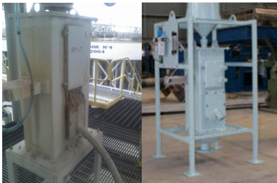
Foto N° 3 Referencia de un muestreador tipo Flap de Compuerta.
