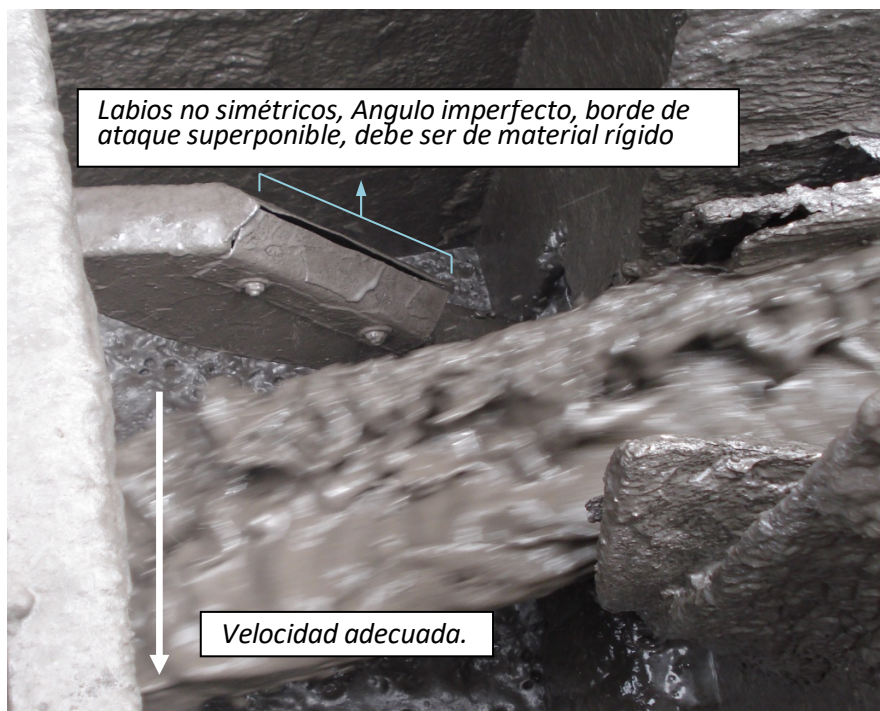
Foto N°2: Efecto del desgaste del cortador por uso o diseño, atravesando el flujo de pulpa en el canal.
