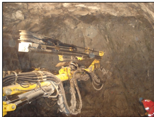
Perforación del frente y preparación de Famecorte para
