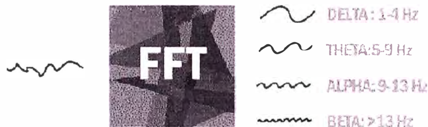
Fig. 1. 22 Señales EEG luego de un análisis espectral FFT
