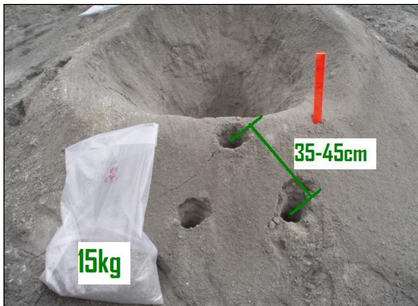
Foto 21: Metodología de las inserciones durante la toma de muestra.
