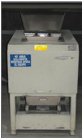
Foto 28: Chancadora Boyd, para obtener finos menos a 2.8 mm.
