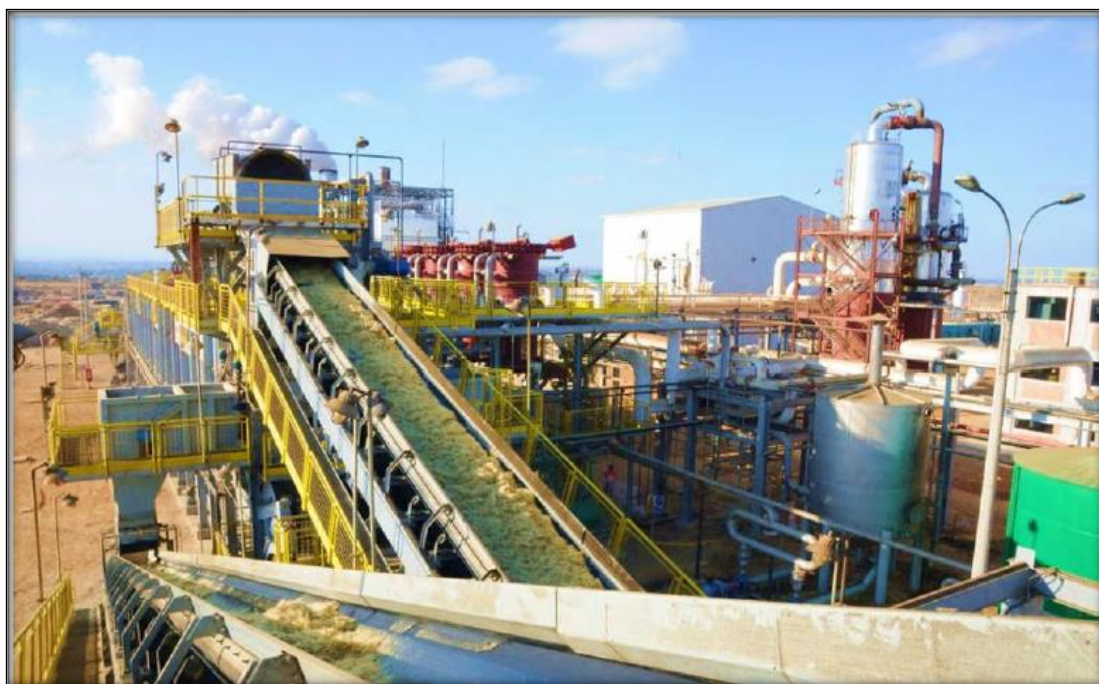
Foto.2.3 Preparación de caña (Cortesía Maple Etanol S.R.L).
