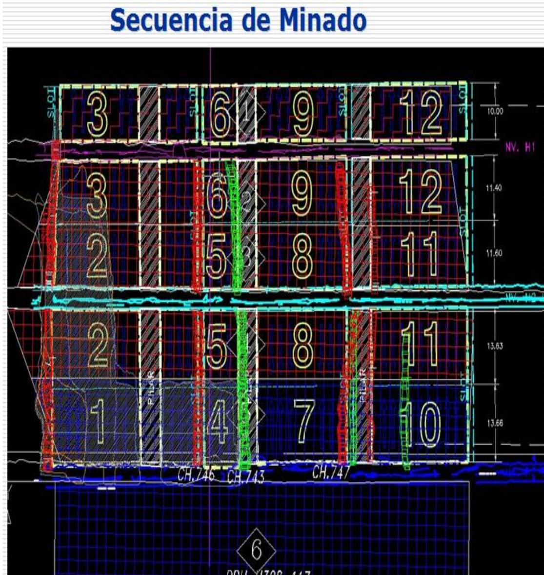
Los datos del carguío son recogido en hojas de control carga para el cálculo y la comparación con los datos del diseño; existe un área de voladura la cual realiza el seguimiento a los parámetros y efectúa el diseño de la voladura, esta área lleva un control de los factores de potencia y los resultados de la fragmentación para mejorar los modelos y las secuencias de disparo en los tajos de taladros largos.
