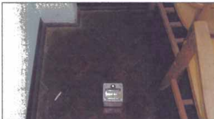
Figura N° 3.2.- Vista del sensor ubicado en el centro geométrico del cuarto piso (equipo del CISMID).
