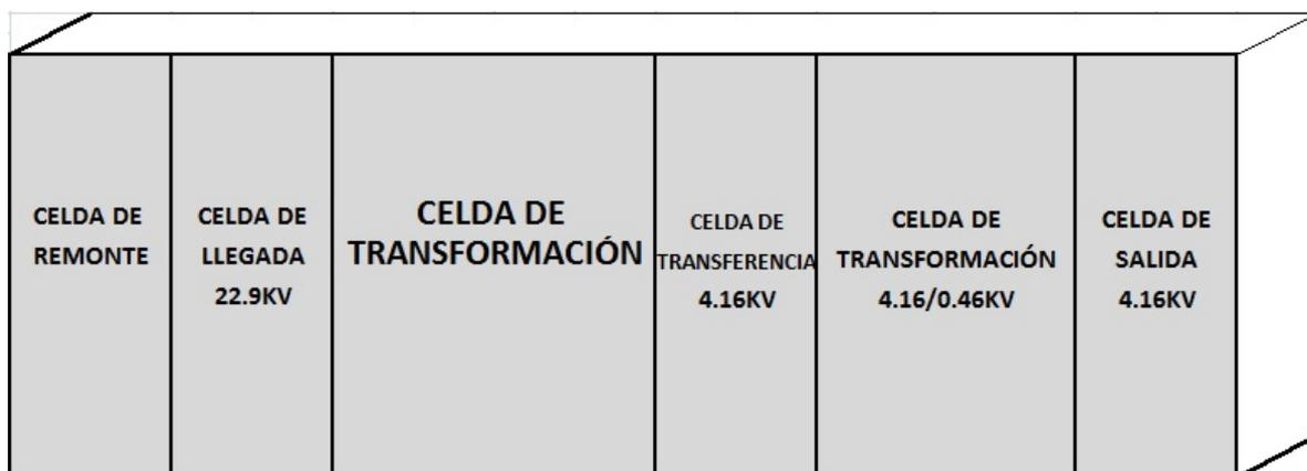
Fig.3.14.-Esquema subestación exterior
