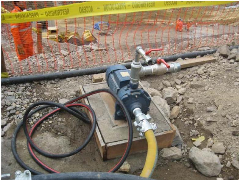
Fig.1.12- Bomba centrífuga
