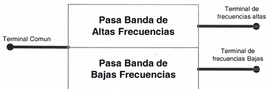
Fig. 1.11 .- División de la Frecuencia por Medio de Filtros
