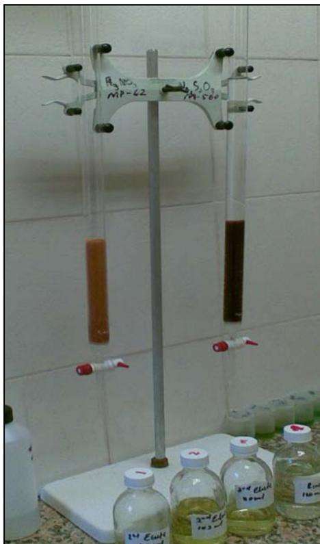
**Figura N° 2.1** Ensamble de buretas con resinas para el 1er paso y 2do paso
