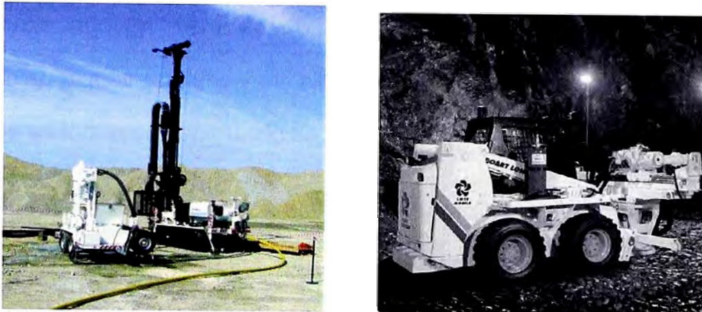
FIGURA 1: PERFORADORA RC y SACA TESTIGO COMPACTA
