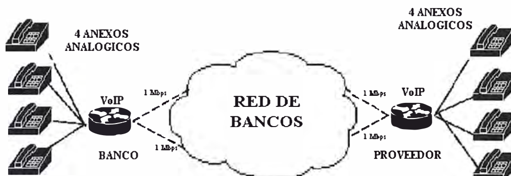
Figura.2.4 - Conexión directa entre anexos a los 4 puertos analógicos FXS
