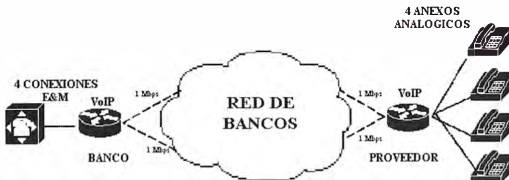
Figura.2.5 - Conexión directa entre anexos con puertos FXS y E&M en una PBX
