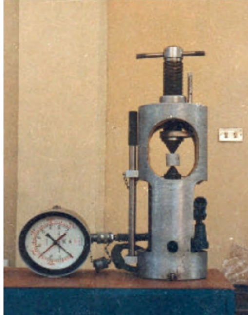
Figura 8. Equipo de carga puntual con probeta lista para el ensayo axial.
