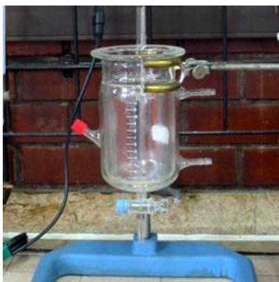
Figura 3.1 Reactor de vidrio utilizado en las pruebas
