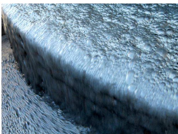
Figura N° 1.6: La espuma mineralizada evacua por el labio de la celda mecánica, recuperando el mineral valioso, en este caso esfalerita (ZnS)
