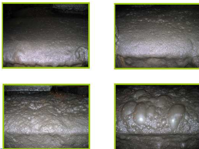
Figura N° 1.7: Diferentes tamaños de burbujas, generados por diferentes espumantes, se encuentra el espumante mas optimo.
