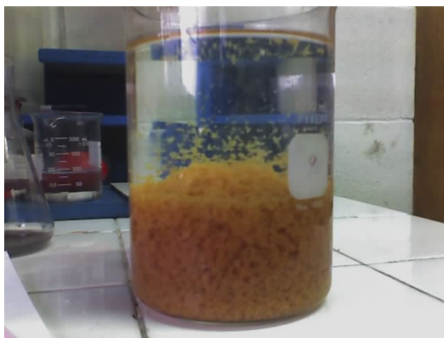
Figura N°5.20: Agua neutralizada con cal, pH = 7.37 y AF 205 = 1ppm
