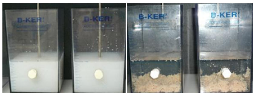
Figura N°4.6: Test de jarras para optimizar la recuperación de pulpa en efluentes evacuados
