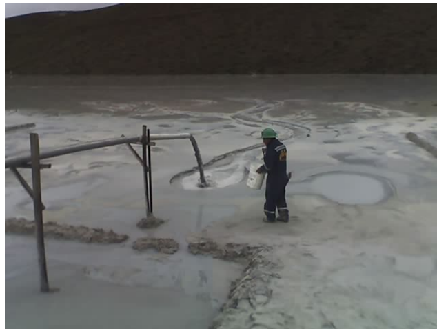
Figura N°5.9: Punto de muestreo de la pulpa de relave. (Over Flow del Hidrociclón)
