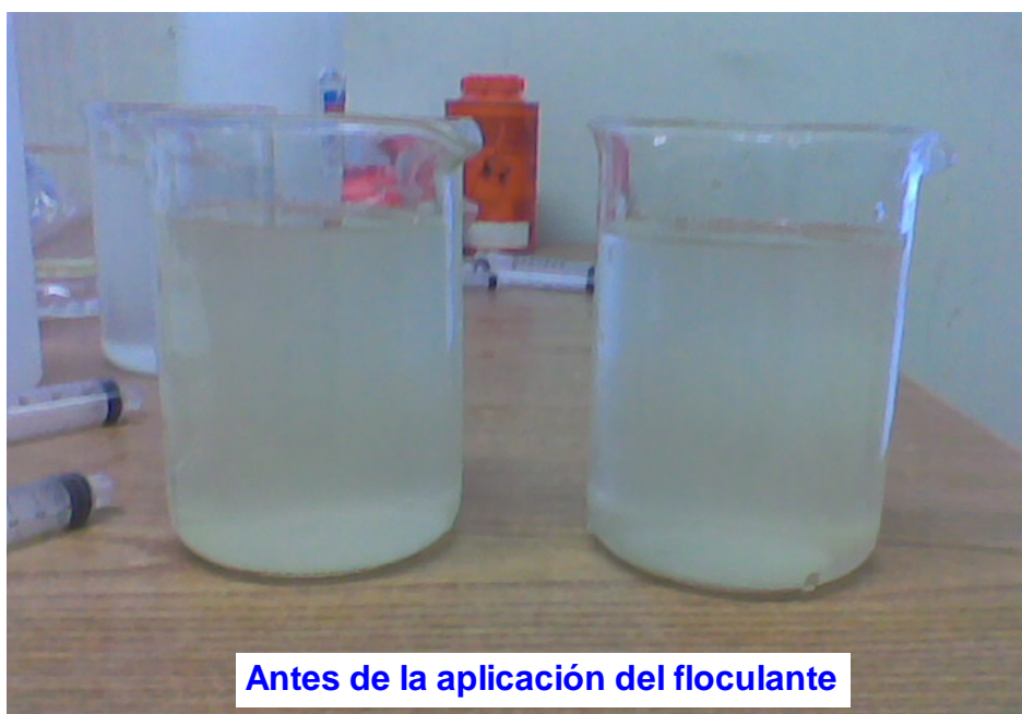
Figura N°5.6: Solución proveniente de quebrada, antes de ser tratada
