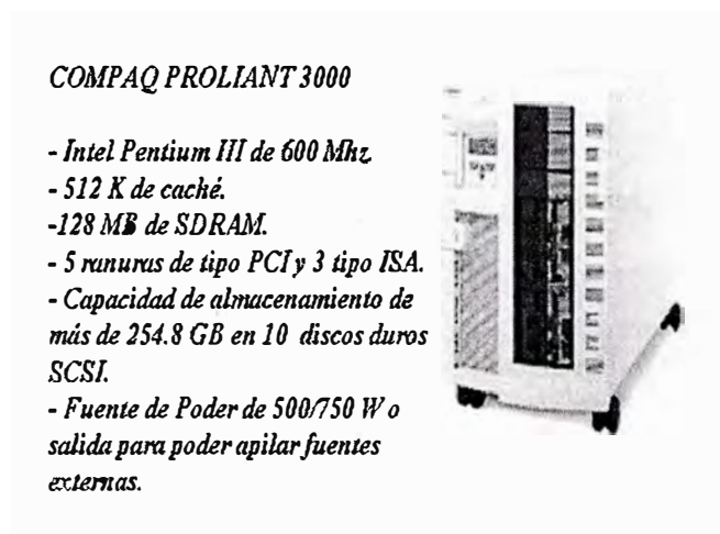
FIGURA N° 52: SERVIDOR DEL SISTEMA RFTS.
