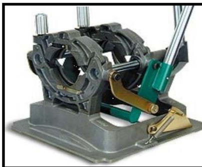
Figura N° 2.1 Máquina termofusión 14 con mordazas simples.
