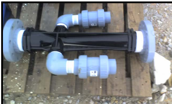
Figura N o 2.11 Venturi con dos entradas
