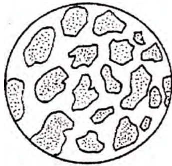
Fig 2,8 No metálica; el cemento es mal conductor
