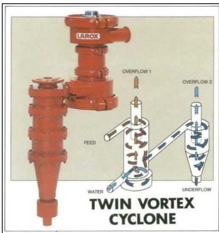
Fig. 2.9 - Ciclón cilíndrico LAROX tipo TWIN VORTEX (Juan Luis Bouso; Nuevos tipos de Hidrociclones, ERAL, Equipos y Procesos, S.A. Mayo, 1990)
