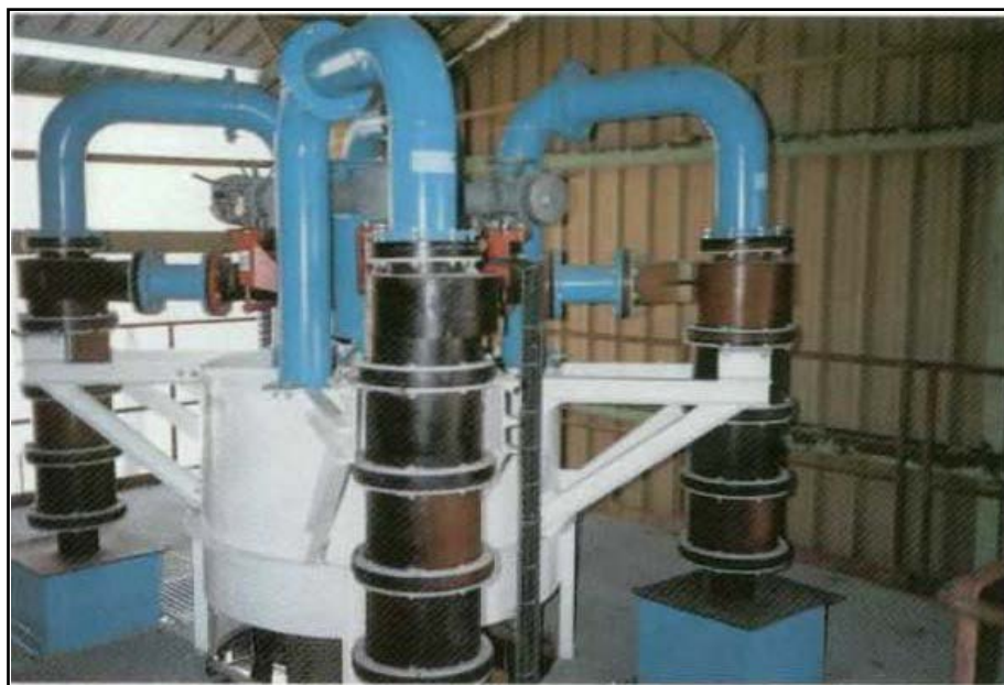
Fig. 2.10 – Ciclón cilíndrico AKW ( \varnothing 200 mm) tipo fondo plano CBC (Juan Luis Bouso; Nuevos tipos de Hidrociclones, ERAL, Equipos y Procesos, S.A. Mayo, 1990)
