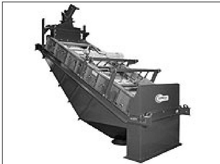
Fig. 2.23 Zaranda Derrick Multifeed (Barrios, G. Aplicación de Zarandas de Alta Frecuencia en Molienda, Goldex S.A.)
