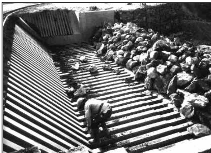
Fig. 2.16. Parrilla de chancado primario (Alcalá Cruz, E.; Flores Corrales, A.; Beltrán Alfonso, A; Manual de Entrenamiento de Concentración de Minerales. Sección IV; Chile)
