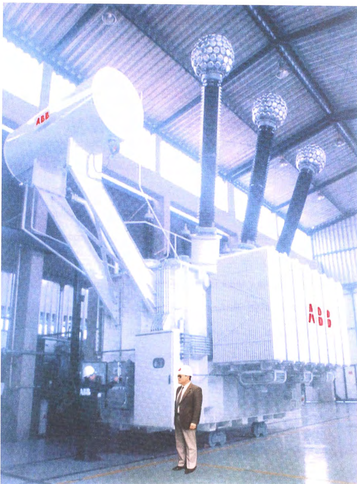
Registro Fotográfico 09. Transformador de Potencia de 75MVA, 220/138 kV
