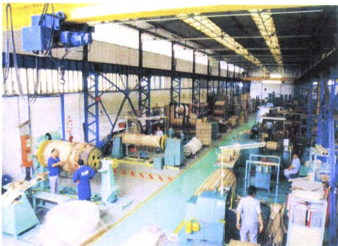
Fig. 2-10 Sección Bobinados de Transformadores de Potencia.
