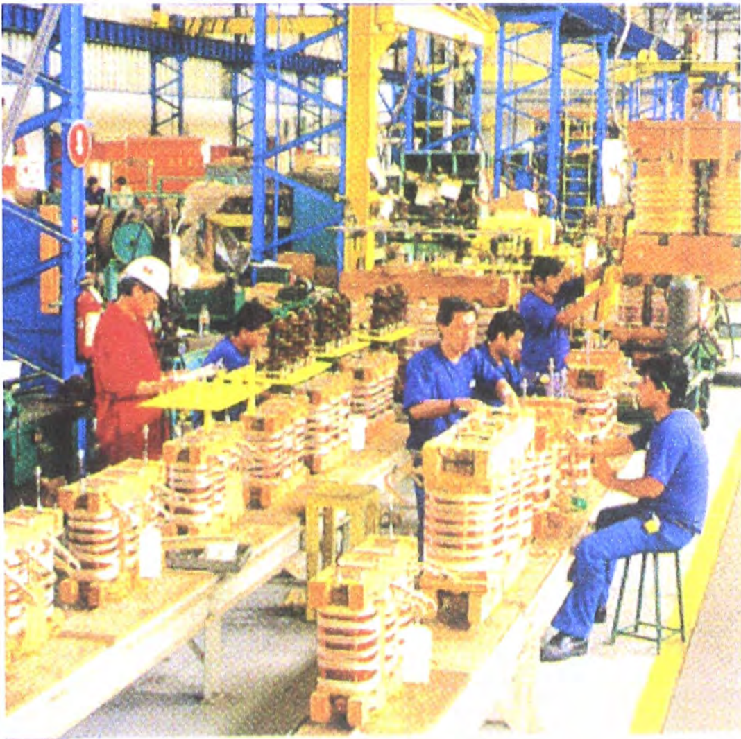
Fig. 2-9. Ensamble del conjunto núcleo-bobina
