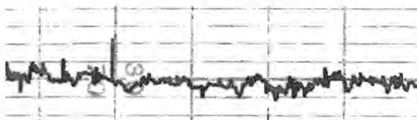
Figura 37. Estudio del limite de detección del método, registro de 11 repeticiones del análisis, Longitud de onda = 605nm, \text{Na}_2\text{S}_2\text{O}_4 , 0.1%(m/v), Solución transportadora: Tampón Borato 0,05M pH=9, Volumen de muestra 300 \mu\text{L} , Caudal de flujo 75 \mu\text{L} /seg. Camino analítico 50 cm. Instrumento Espectrofotómetro Micronal B382.
