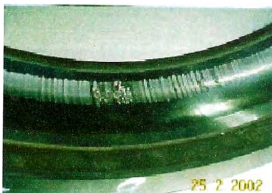
Fig 3.24 Aro exterior de rodaje dañado
