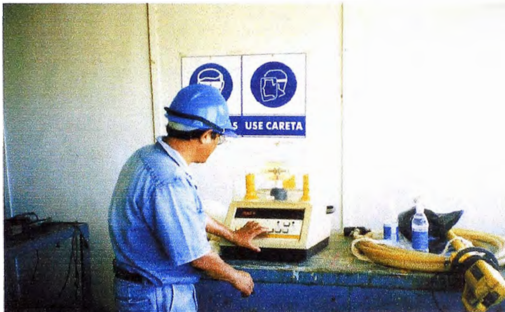
7.2 Prueba de rigidez dieléctrica con espinterometro BAUR
