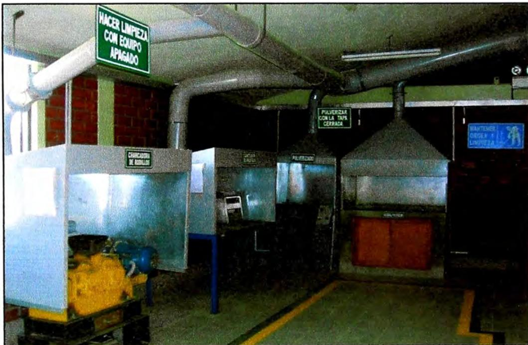
Foto 17: Equipo para chancado y pulverizado de muestras.
