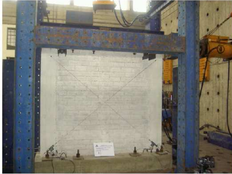
Foto 1: Montaje e instrumentación del muro a ensayar
