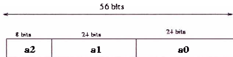
Figura 5.1: Estructura del Acumulador del DSP56002
