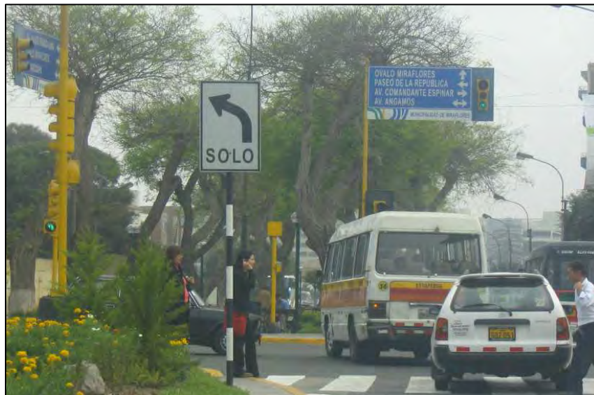
Fig. 3.02.19. Muestra una aplicación de la señal R-5-1, indicaría que el carril de la izquierda solo puede girar hacia la izquierda, sin embargo en la Av. Arequipa mostrada, el referido carril tiene toda la opción de seguir de frente.
