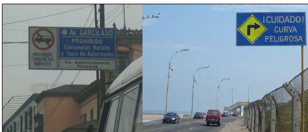
Fig. 3.4.01 Señales informativas que incorporan otras señales, ciudad de Lima. El panel de la izquierda está sobrecargado de mensajes
