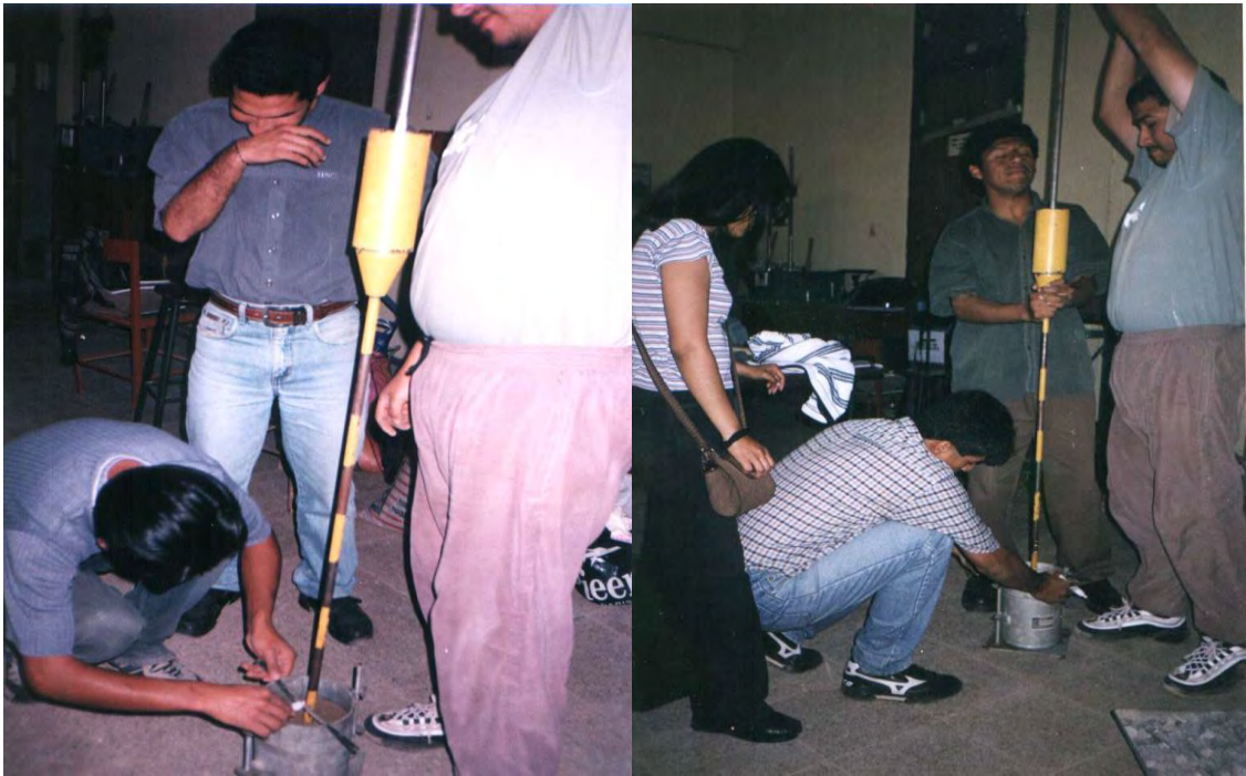
Figura 4.12: Se observa los ensayos en suelo compactado en molde CBR trabajos realizados en el año 2002 en el antiguo laboratorio de mecánica de suelos de la FIC. UNICA
