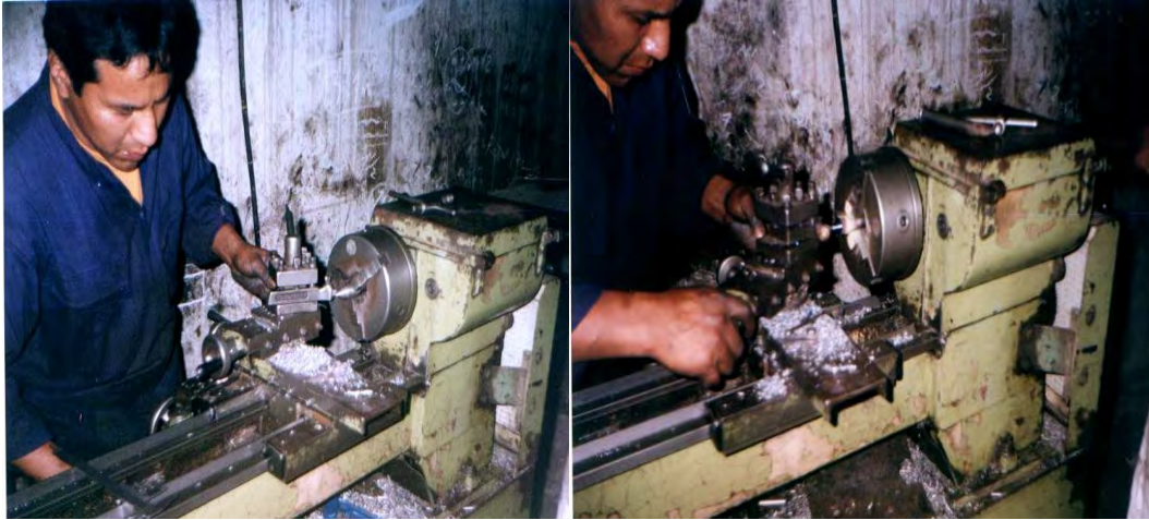
Figura 3.6: Se observa el proceso de formación de punta cónica 60°
