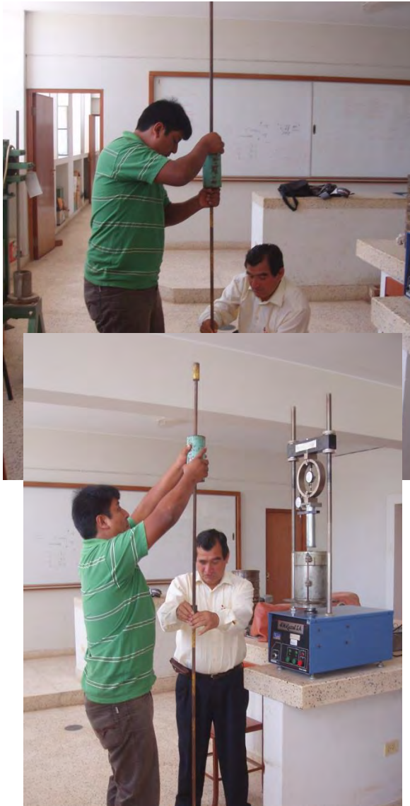
Figura 4.11: Se observa el procedimiento de ensayo con el PDC a una muestra preparada en el molde CBR. (Ensayos actuales 2012)
