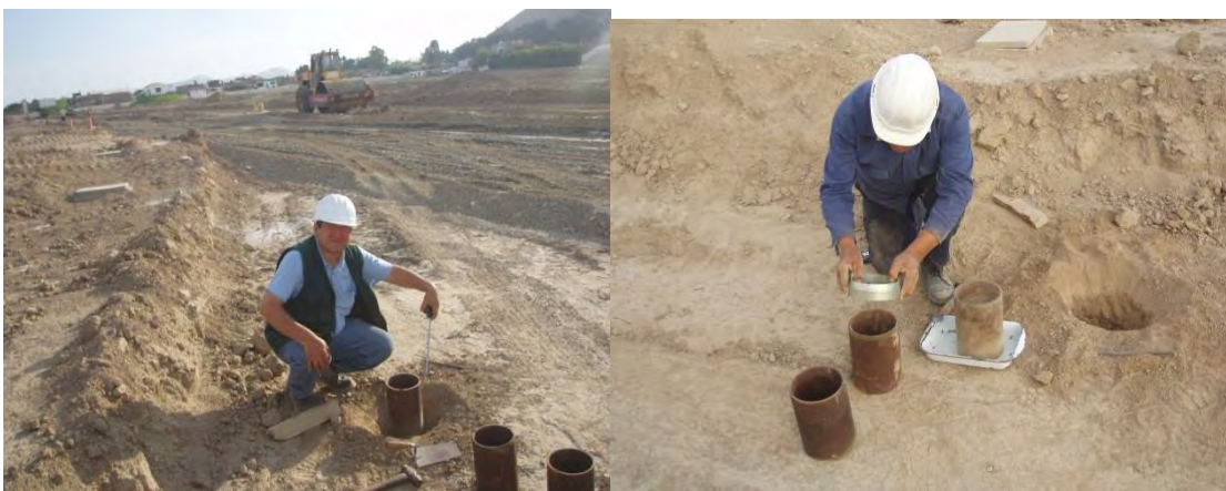
Figura 4.7: Se observa moldes y anillo de corte en extracción de muestras
