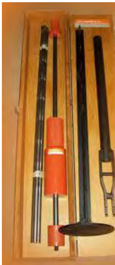
Figura 3.2: Muestra los equipos PDC con sus estuches de madera
