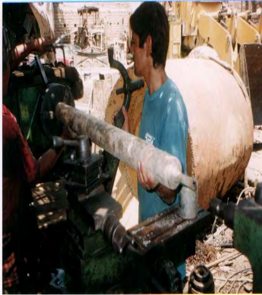
Figura 3.7: Se observa la formacion del martillo al cortar en torno un eje de acero
