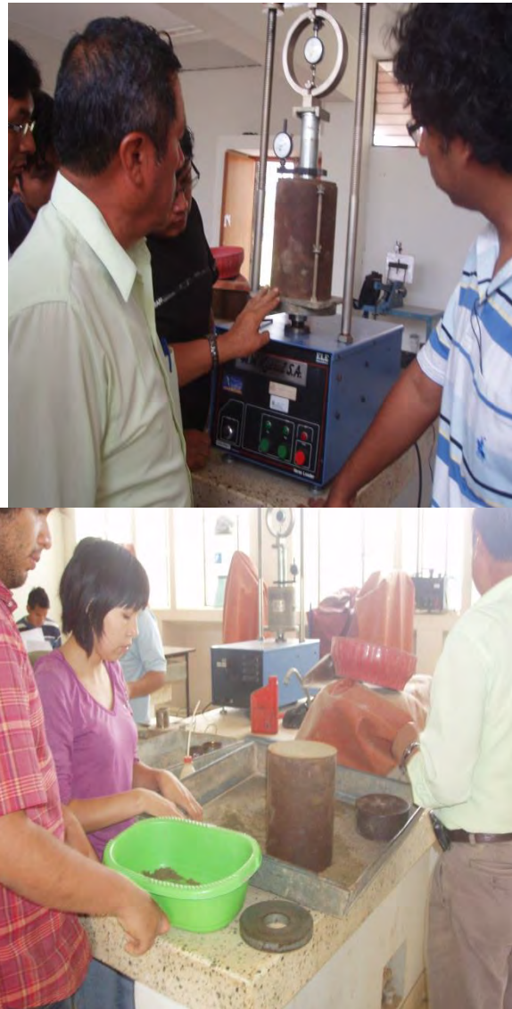
Figura 4.8: Se observa la preparación y ensayo del molde CBR con la muestra.
