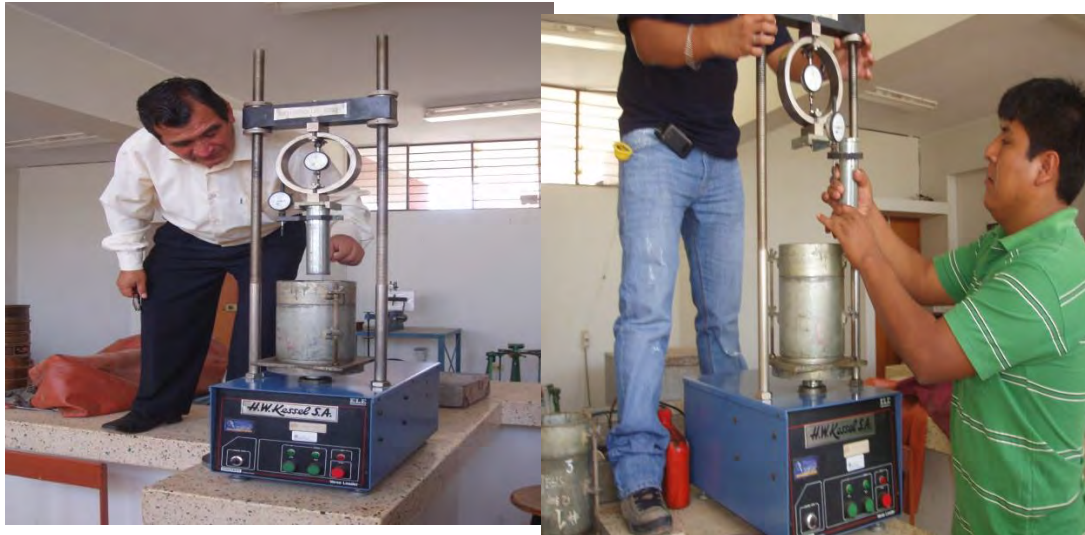
Figura 4.9: Se observa el procedimiento de preparación del equipo CBR y la verificación que el vástago de penetración este en la altura conveniente.
