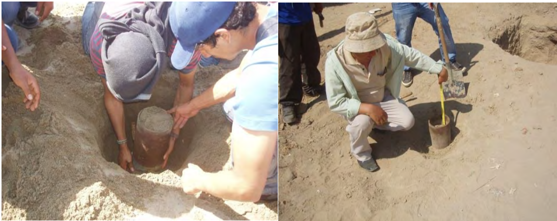
Figura 4.6: Se observa el proceso de extracción de muestra inalterada
