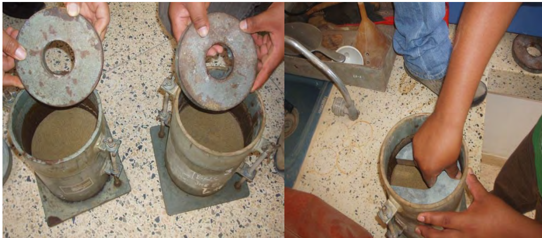
Figura 4.10: Se observa la colocación de la sobrecarga conveniente en el molde de ensayo CBR.
