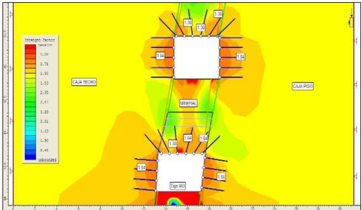
Figura 24: Factor de Seguridad en el Tajo 863 con el PHASES 2
