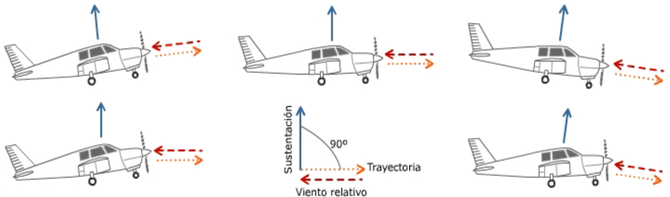
La sustentación es perpendicular al viento relativo, que es paralelo y opuesto a la trayectoria.
