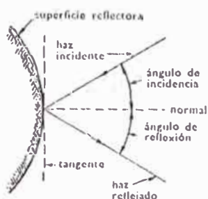
Figura 1.18 Cuando un haz de microondas llega a una superficie reflectora se refleja la onda de modo que el ángulo de incidencia es igual al ángulo de reflexión.
