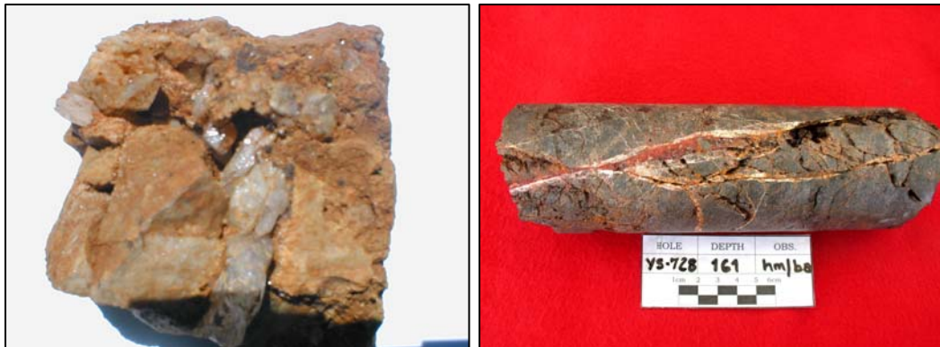
Foto.03. Baritina en cristales gruesos formando parte de la matriz de la brecha freática (Izquierda). Baritina en finos cristales con hematita relleno de fracturas (derecha).
