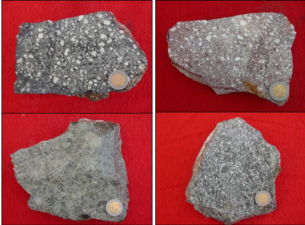
Foto.07. Rocas andesíticas porfíricas. Yp de grano grueso propilítico (superior e inferior izquierda) y argílico (superior derecho). Cp de grano fino con pirita finamente diseminada alterado a argílico.
