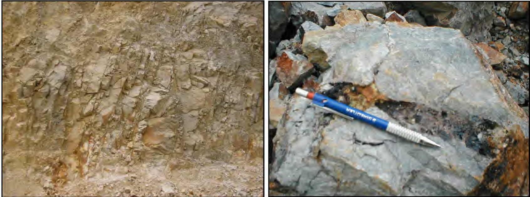
Fig.36. a) Junturas de tipo 1 mineralizadas o rellena de limonita b) Fractura rellena de material triturado con limonita.
