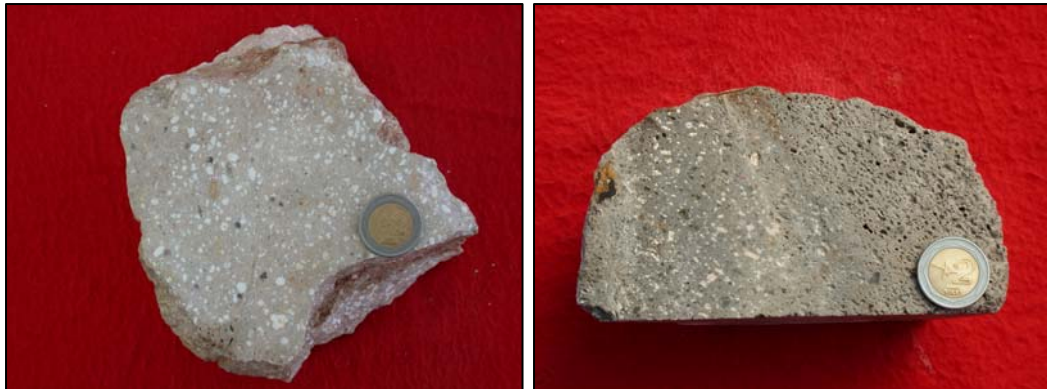
Foto.08. Rocas dacíticas, característico por los ojos de cuarzo. Roca alterada a sílice-alunita (izquierda) y sílice-alunita gradando a sílice vuggy (derecha).
