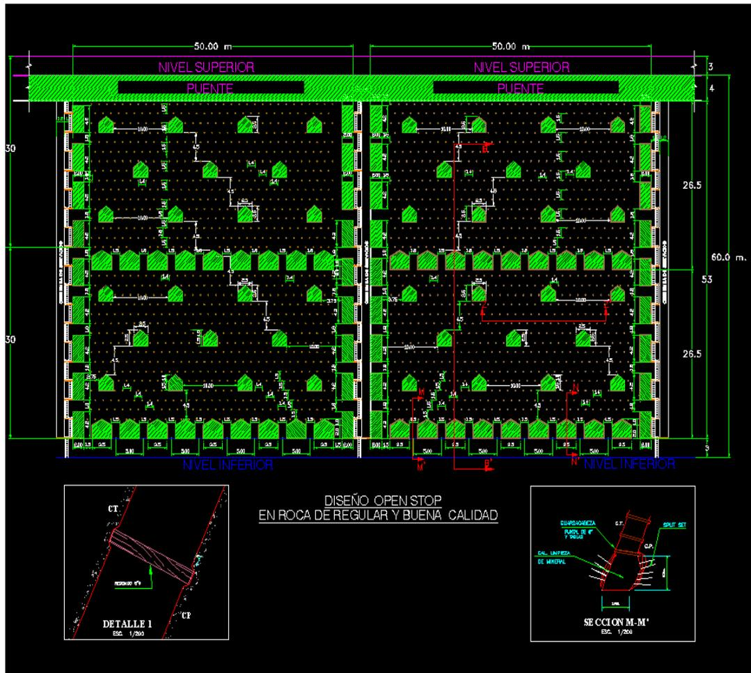
Fig.8 Fuente: área de Ingeniería. Estándar de diseño de Open Stop.
