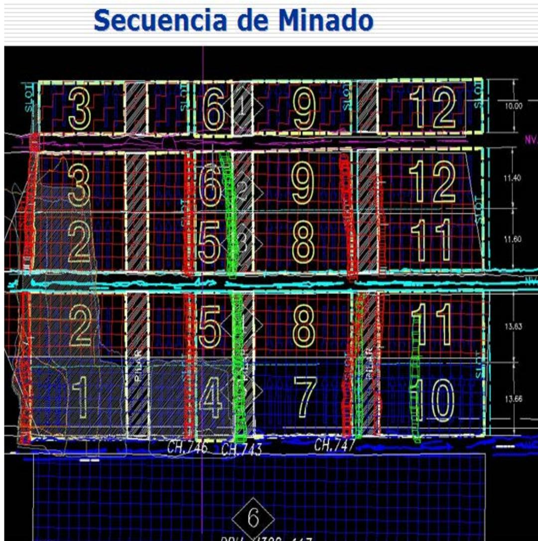
Fig. 20 Fuente: área de Ingeniería. Secuencia de Minado en un tajo de Subnivel Stopping Cuerpos.
