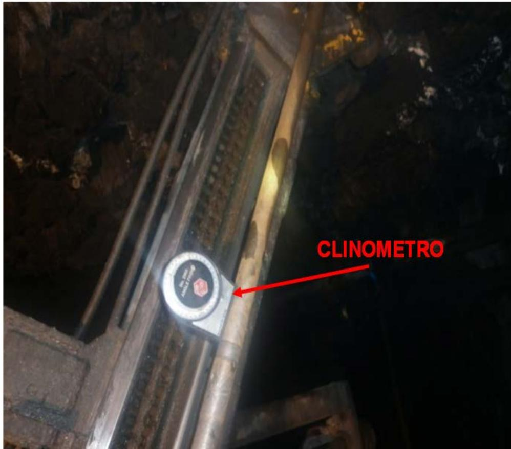
**Fig.17 Colocado del clinómetro para el ángulo de perforación.**
