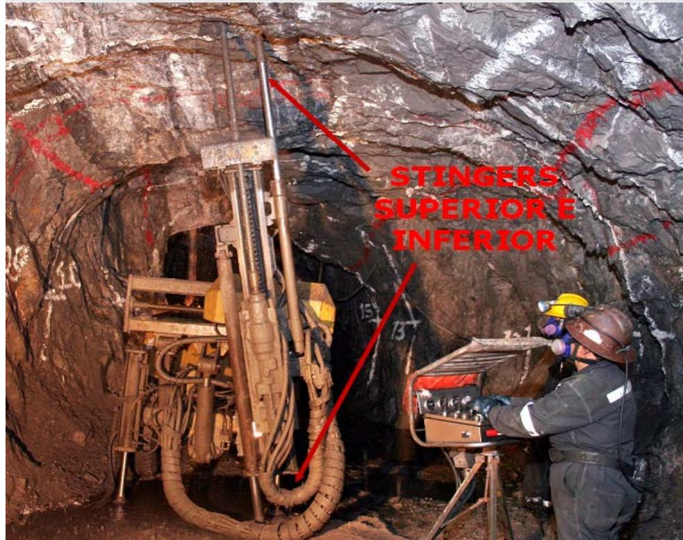
**Fig.18** Uso adecuado de los stingers superior e inferior.
