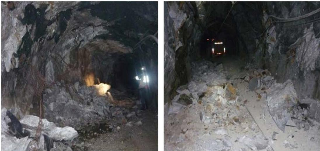
Fig. 25 Fotos de reventazón de roca en interior mina.
