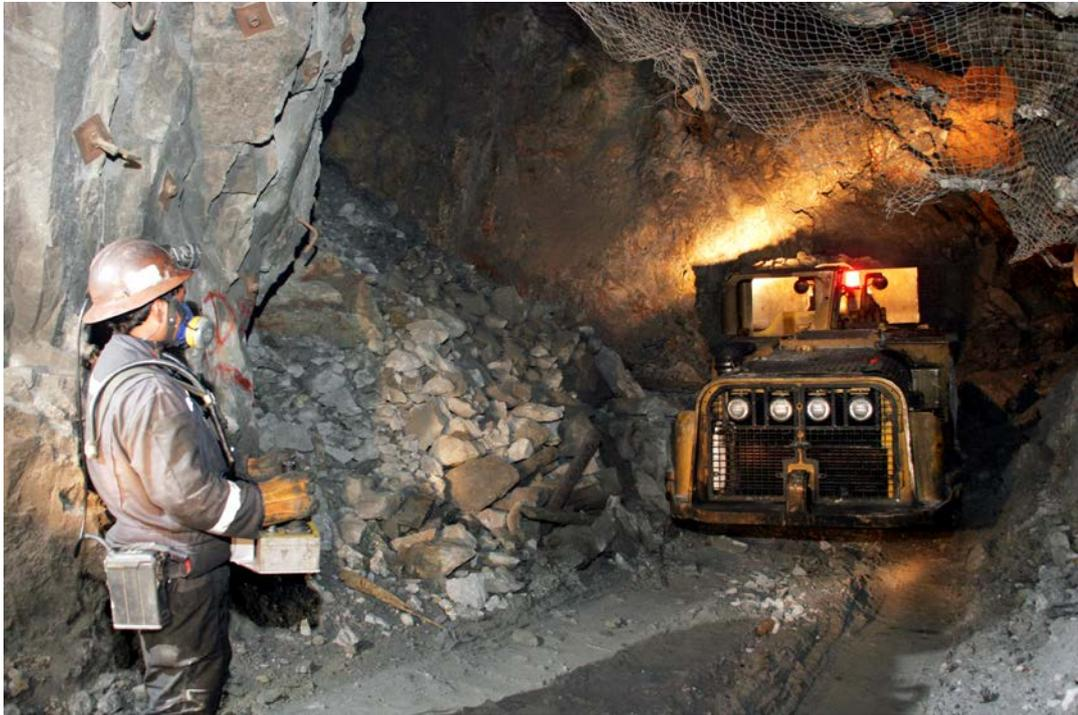
**Fig 22: Operador controlando el scooptram de 3.5 yd<sup>3</sup> mediante el telemando.**
