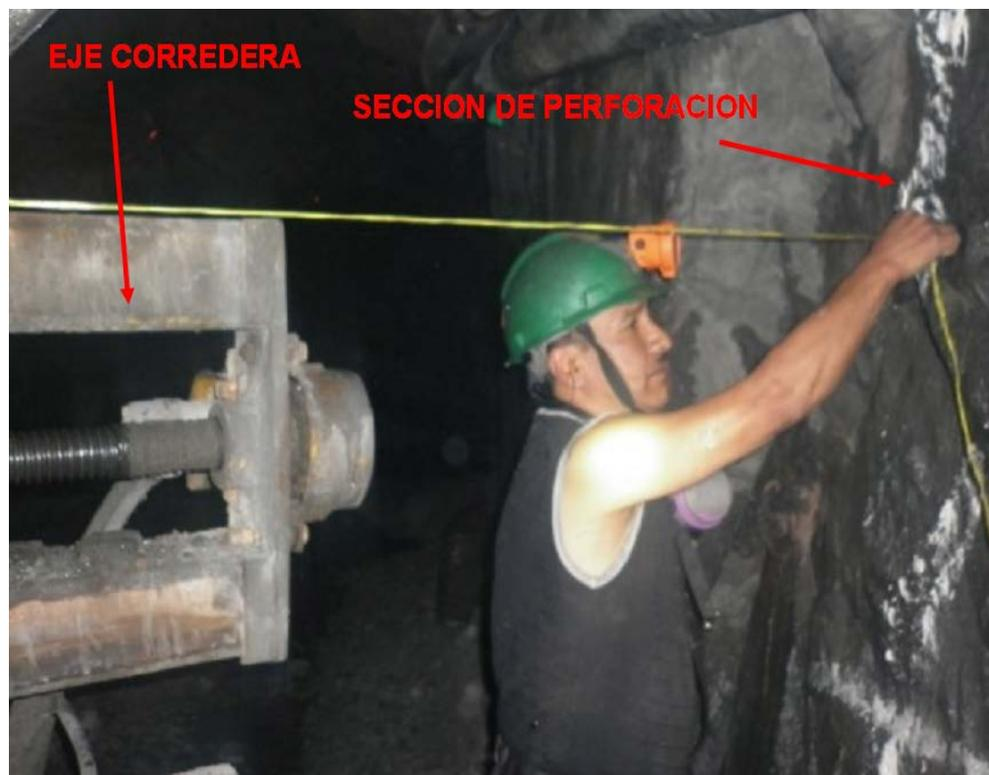
**Fig.14** Alineamiento del eje de corredera con la sección de perforación.
