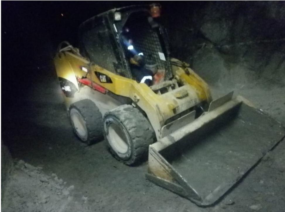
**Fig. 53 Equipo Bob CAT para mantenimiento de vías en interior mina.**
