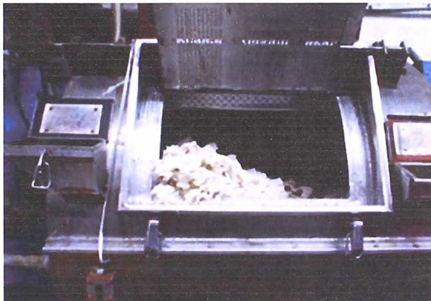
**Figura 1.** Lavadora industrial de 50 L de capacidad utilizada en el proceso de teñido.
