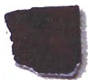
**Figura 28.** Electrodo de Ti/Co<sub>3</sub>O<sub>4</sub> al finalizar la prueba de estabilidad.
