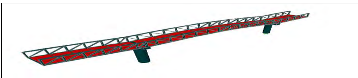
Figura 5.19. Tercer tramo del puente peatonal, con influencia de pesos adyacentes
