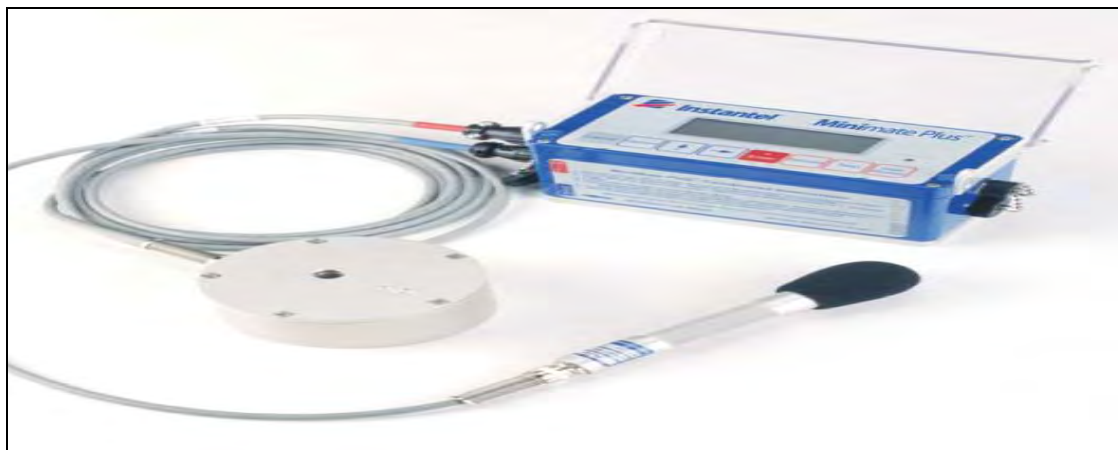
Figura 5.2. Equipo monitor de vibraciones utilizado en el estudio, fuente: INSTANTEL
