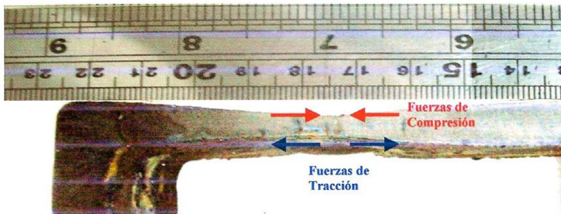
**Fig. Nº 1.12.** Fuerzas de compresión y tracción que surgen al formarse un espacio de aire "Gap". Sección transversal de la cara lateral derecha aproximadamente a 25 cm debajo de la parte superior del menisco, Acero Medio Carbono.
