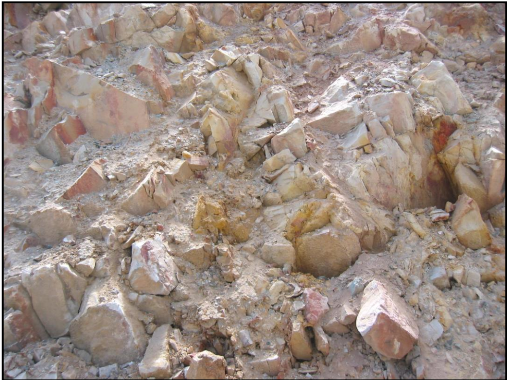
Foto 4: Margas. Esta roca se intemperiza rápidamente en presencia del agua, disminuyendo su calidad, siendo necesario utilizar cimbras en subterráneo.
