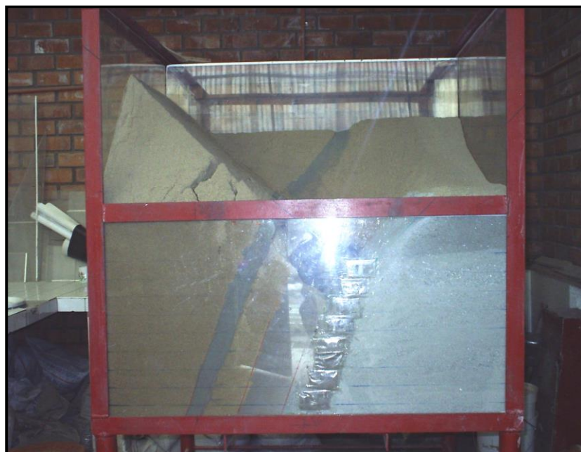
Fin de la explotación. Obsérvese el fracturamiento de la caja techo. La caja piso presenta mayores deformaciones.
