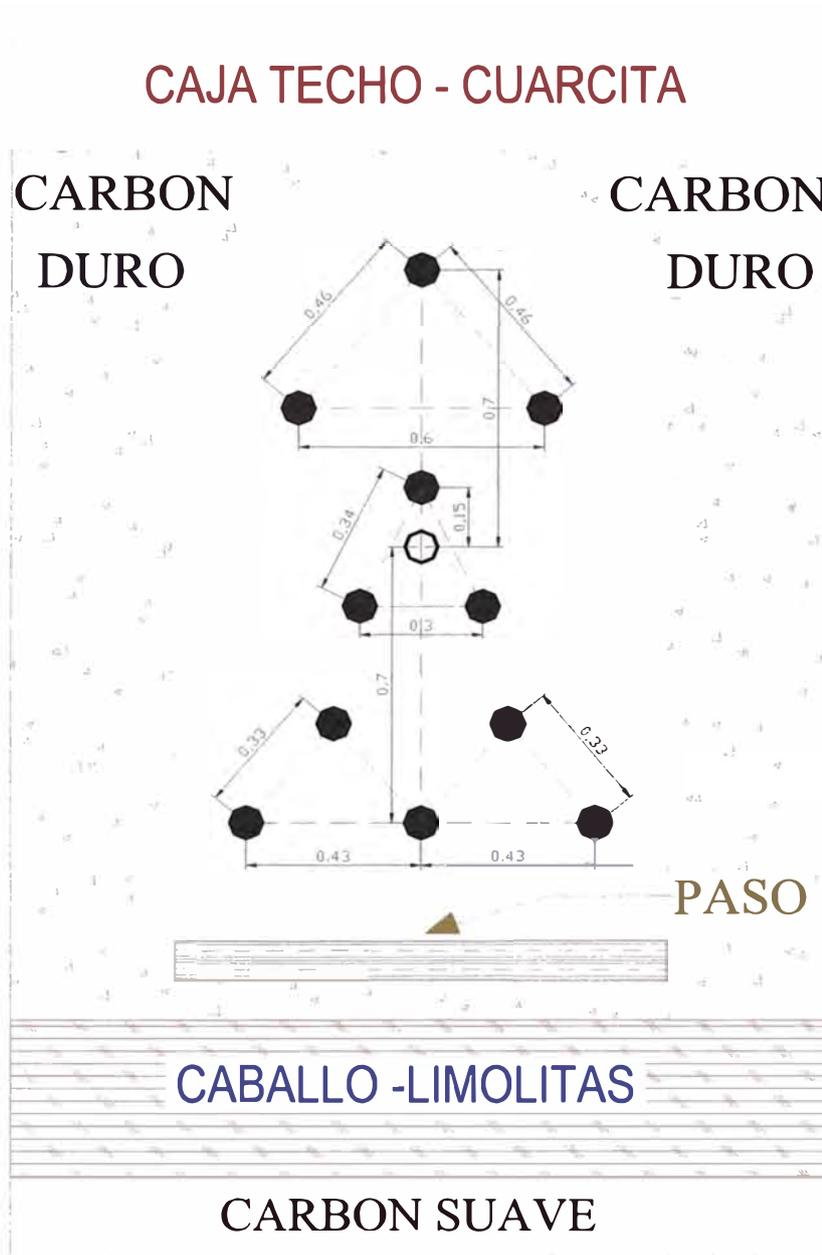
**Ilustración 04:** Malla de perforación de frente de subnivel en carbón sección 1.8mx2.0m.
