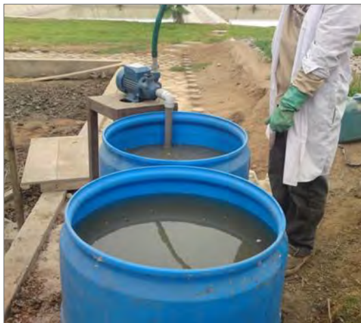
Figura 46. Inicio de las diluciones de Lixiviado con agua residual.
