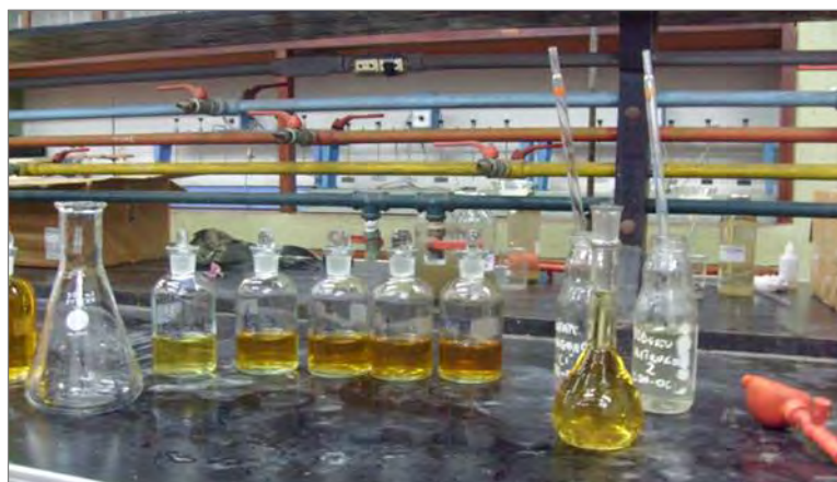
Figura 31. Materiales y reactivos rutinarios en la determinación del OD.
