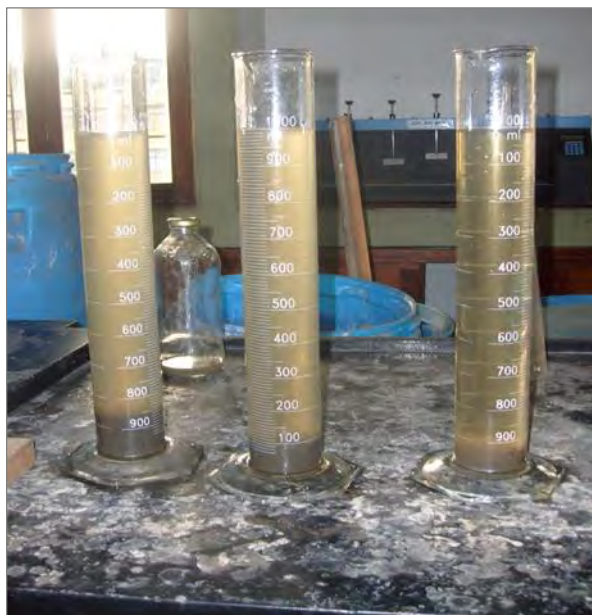
Figura 32. Determinación del IVL en cada reactor.
