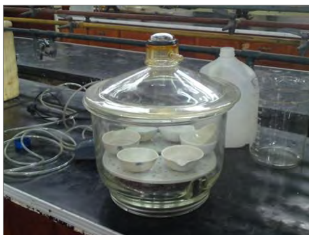
Figura 33. Acondicionamiento de las cápsulas antes de ser pesadas.
