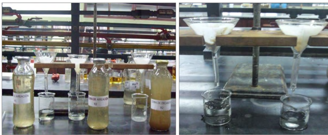
Figura 34. Acondicionamiento y filtración de cada muestra.
