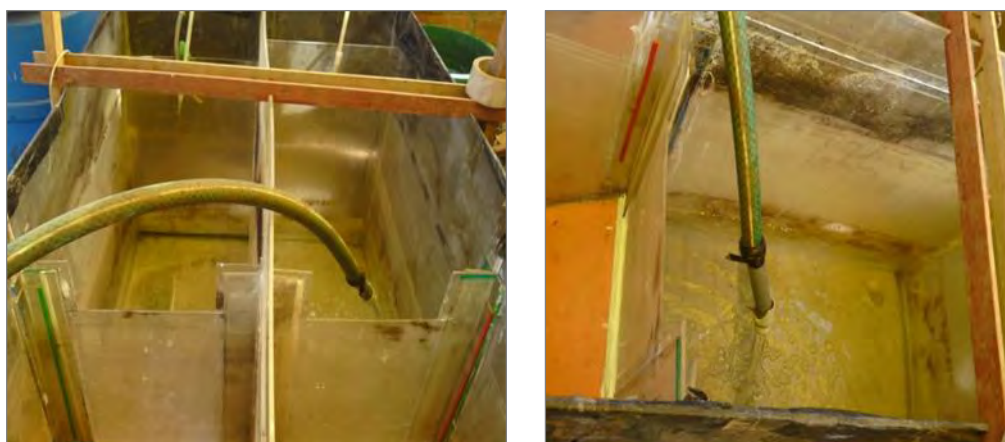
Figura 25. Prueba hidráulica a la planta de tratamiento a escala piloto.
