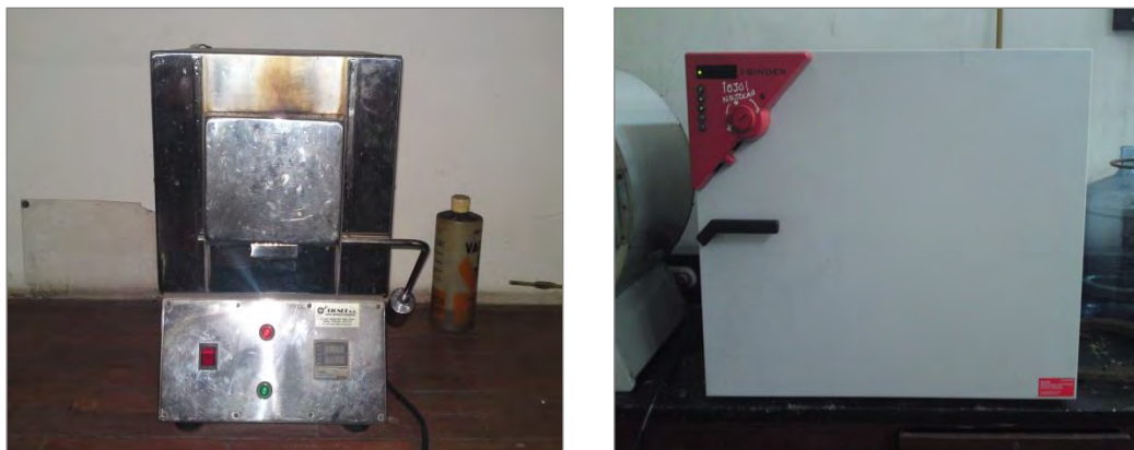
Figura 35. Horno y mufla empleados en la determinación de los sólidos.
