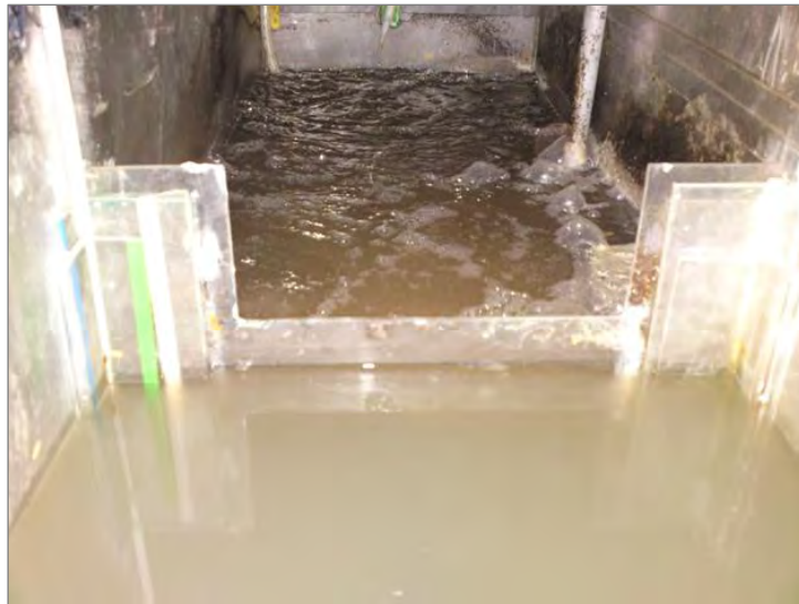
Figura 26. Prueba del sistema para la capacidad de oxigenación.
