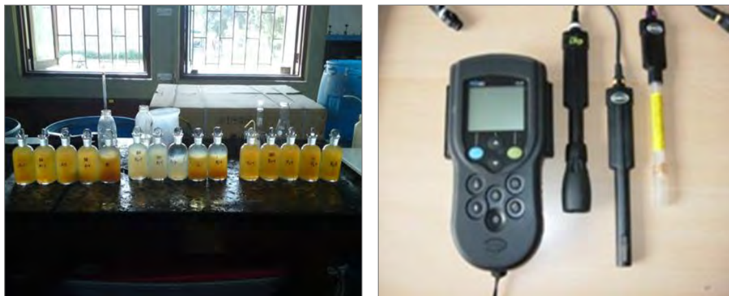
Figura 27. Métodos y equipos empleados para la determinación de OD.
