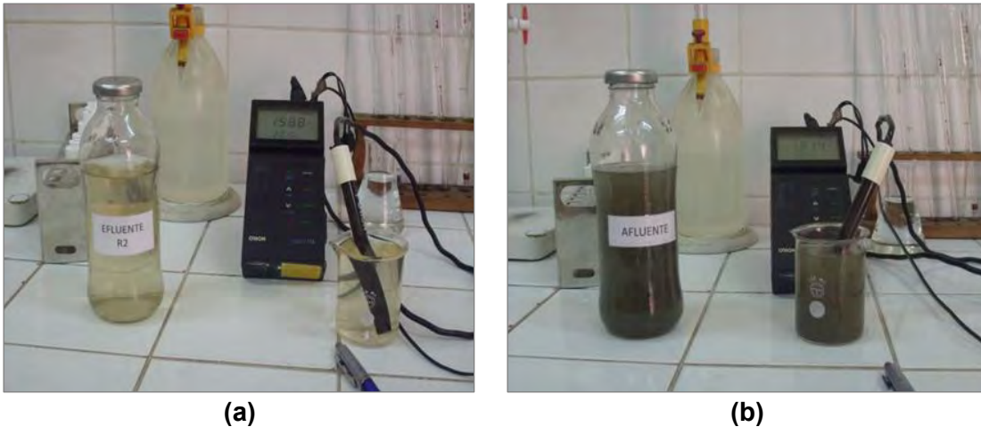
Figura 29. Equipo y materiales para determinar la conductividad.
