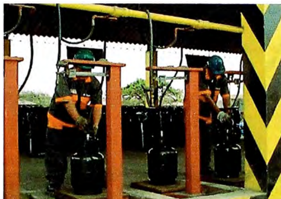
Figura 2-3 Envasado de cilindros (foto captada durante visita de supervisión)
